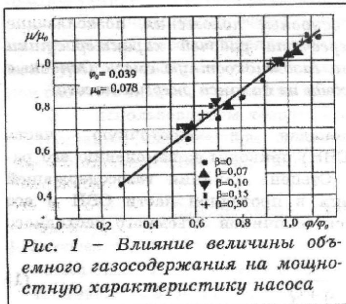
Рис. 1 – Влияние величины объемного газосодержания на мощностную характеристику насоса
